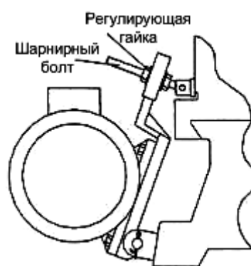
Рис. 6 Натяжка V-ремня (токарная обработка)
